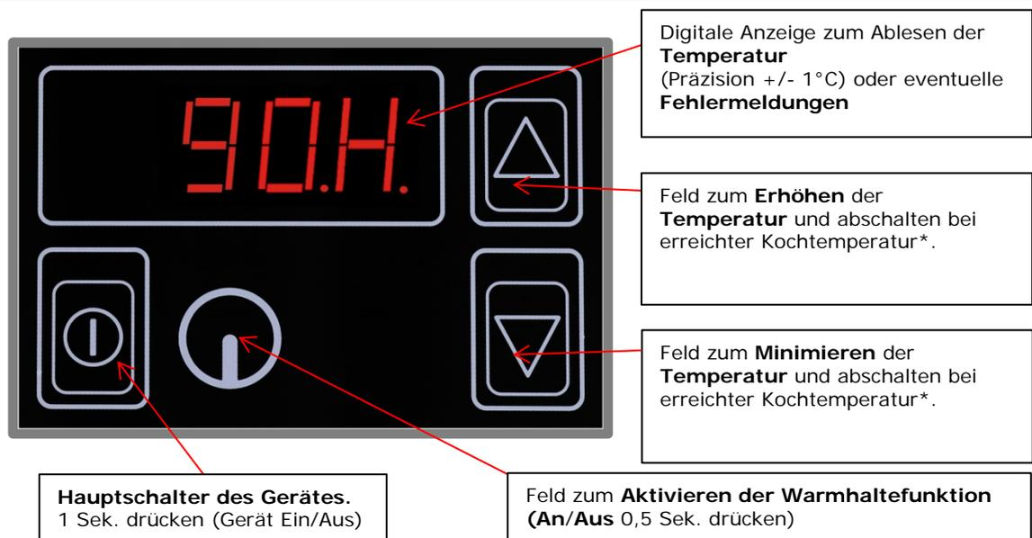
Bei den Tasten zeigt je eine LED an, dass die Bedienung der Taste erkannt wurde.
