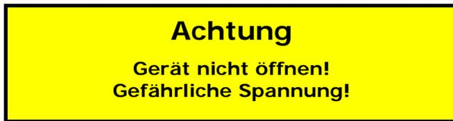
Bei allen Störungen des Gerätes, die nicht auf äußere Einflüsse oder Verschmutzungen zurückzuführen sind, darf nur zugelassenes und geschultes Servicepersonal das Gerät öffnen. Das Gerät muss sofort ausgeschaltet und der Netzstecker heraus-
