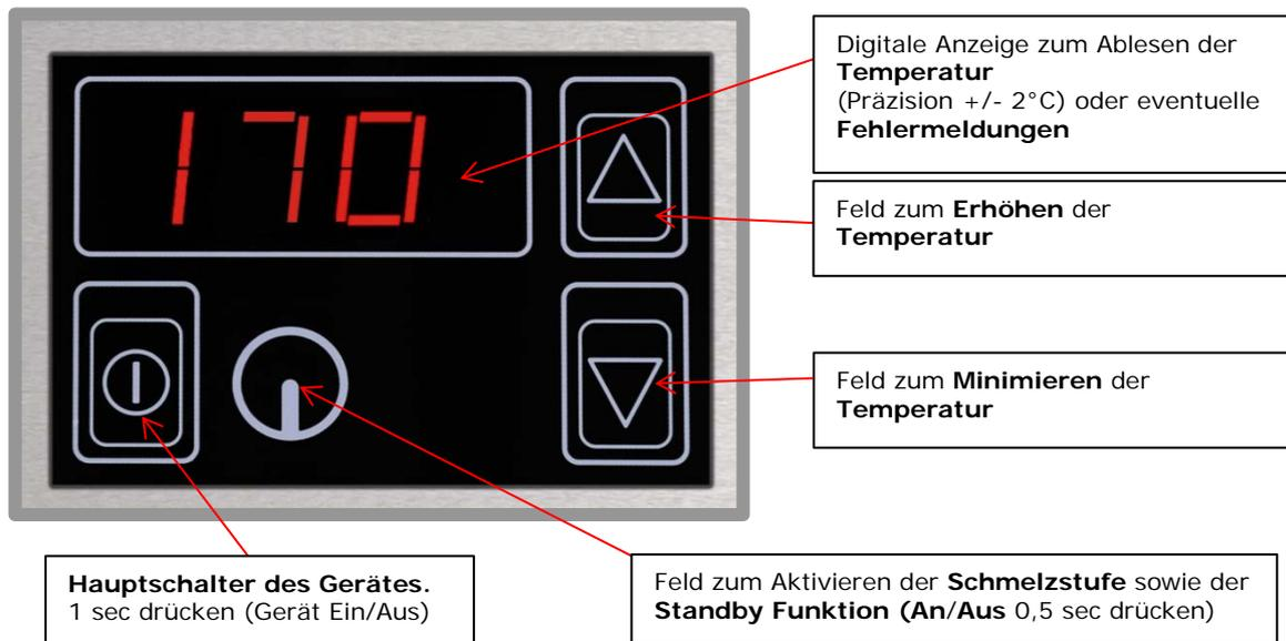
Bei den Tasten zeigt je eine LED an, dass die Bedienung der Taste erkannt wurde.
