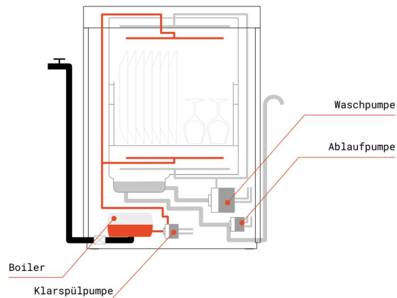
Das HTR+ System verhindert in Kombination mit dem atmosphärischen Boiler und Thermostop, dass kaltes Nachspülwasser während des Nachspülvorgangs eindringt, und hält die Temperaturen bei bis zu 87 °C. Das selbstanpassende HTR+-System passt die Wassermenge an jede Ladung an, während das intelligente Spülmanagement eine gleichbleibende, zuverlässige Leistung für gleichmäßige, gründliche Ergebnisse jedes Mal gewährleistet.
