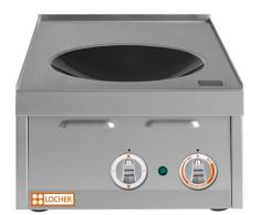
Gehäuse und Abdeckung aus mehreren Teilen gefertigt. Ceranglas flächenbündig in die Abdeckung eingesetzt. Abdeckung hinten 20 mm aufgekantet und flächenbündige Verbindung mit Haarfuge.
